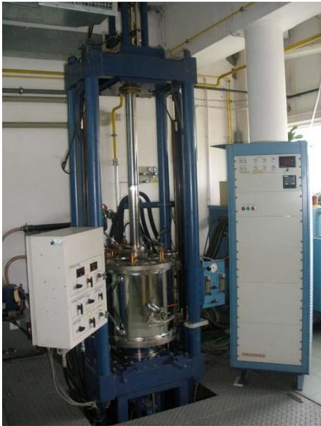
Fig. 1. Thermal Technology Astro uniaxial hot press
